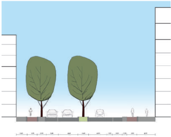
Doorsnede A - Duitslandlaan, links bestaande situatie, rechts nieuwe inrichting met singel
