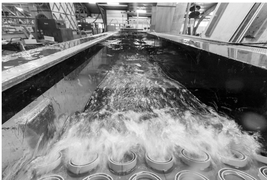
Figuur 1-3: Golfremmende werking van de ringen tijdens kleinschalige testen (1:18) bij DHI in Denemarken
