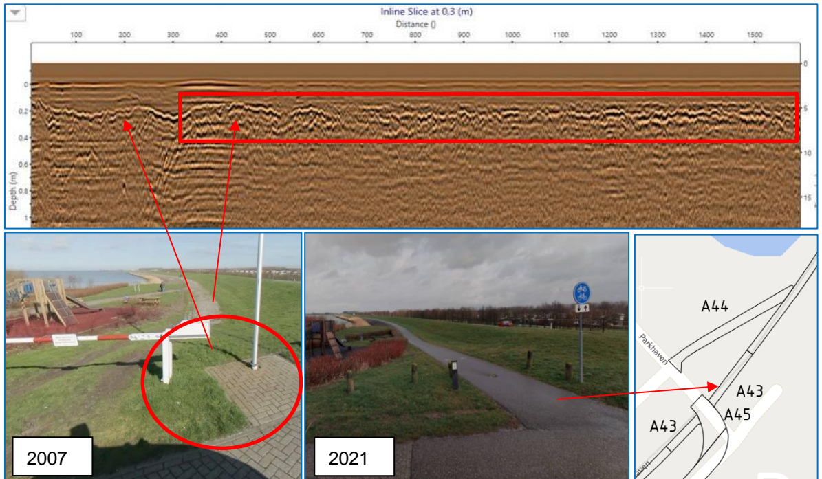
Figuur 11: Klinker verharding onder aanwezige asfaltconstructie.
