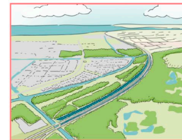
Boog van Lelystad: hoger oplopende panelen in de buitenberm accentueren de bocht.
