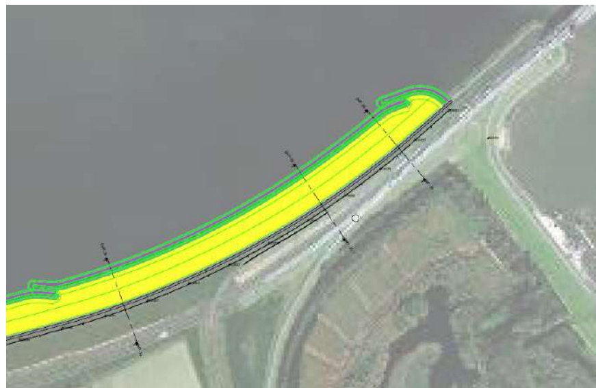
Bovenaanzicht met doorstroomopening in vooroeverdam
