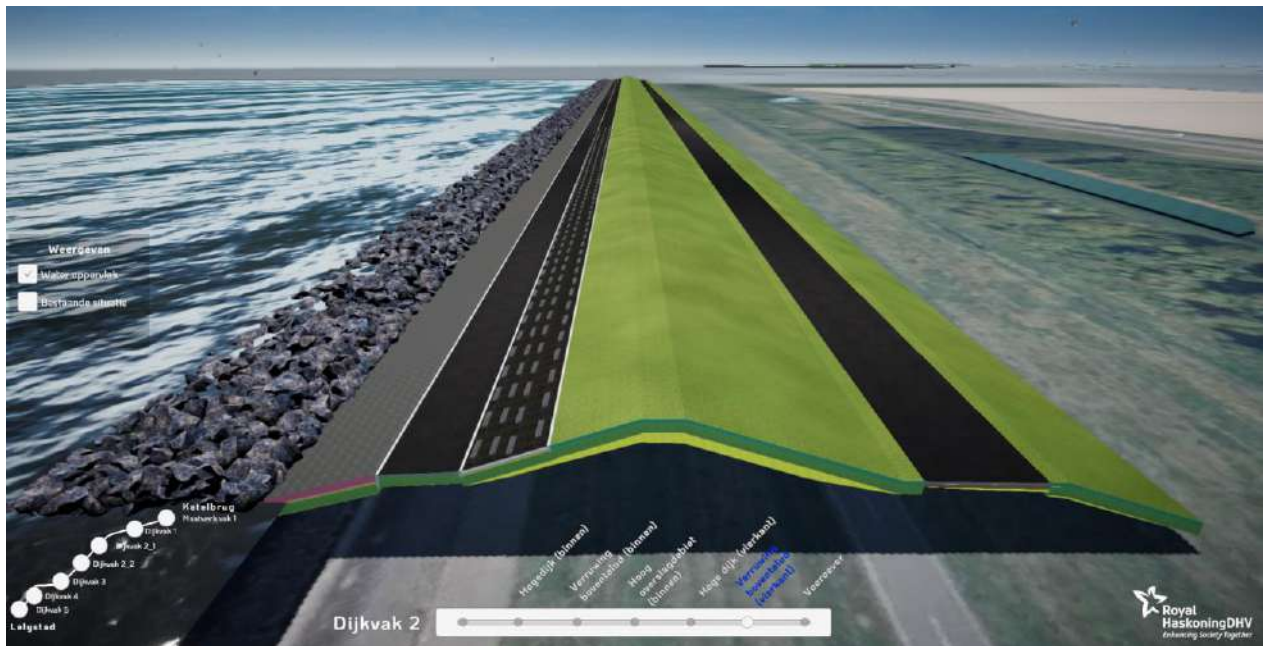
Figuur 2-18: Versterkingsprofiel alternatief Vierkante Versterking – Golfploopbeperkende Bekleding, dijkvak 1/2 altn. 1.5 en 2.5
