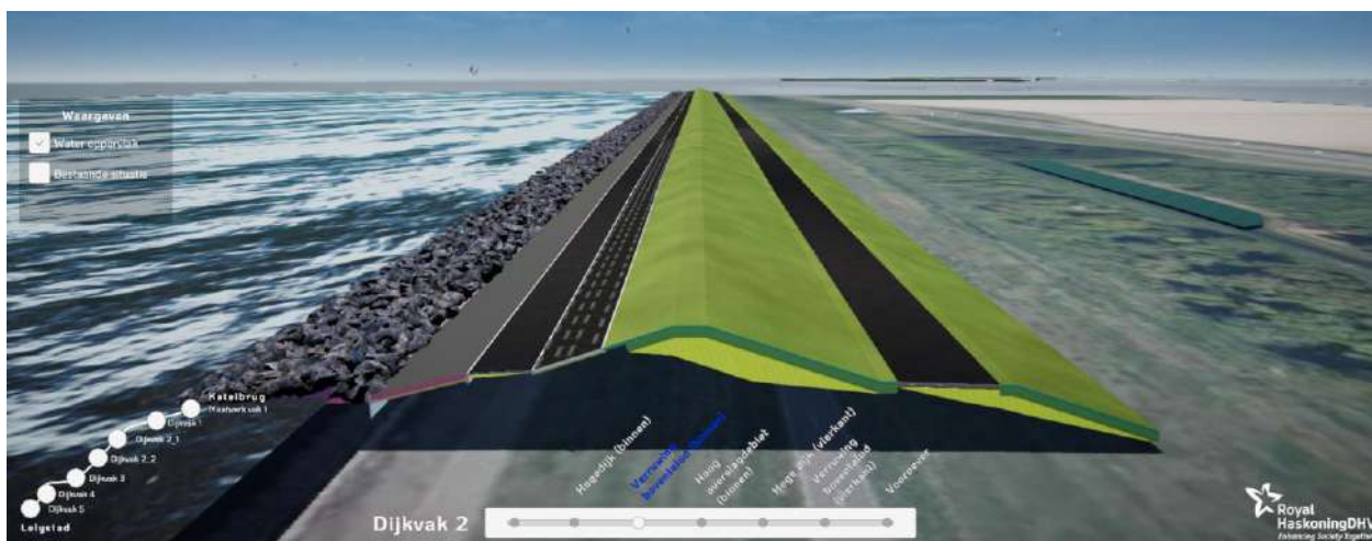
Figuur 2-8: Versterkingsprofiel alternatief Binnenwaarts/buitenwaarts met Golfoploopbeperkende Bekleding, dijkvak 1/2 altn. 1.2 en 2.2
