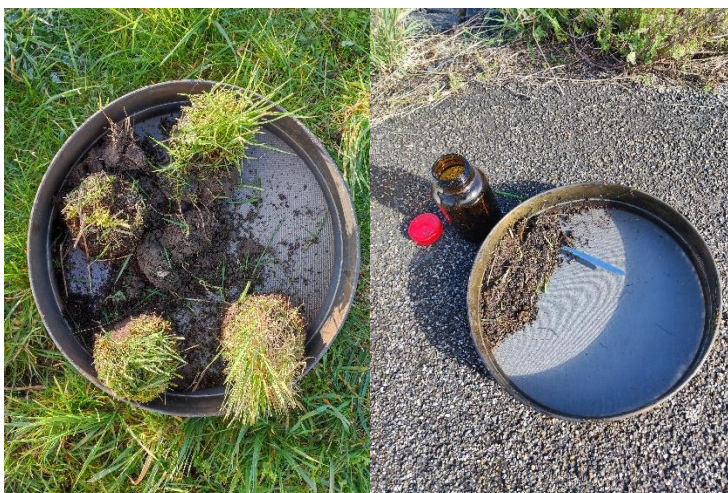
Figuur 3 Ongewassen bodemmonster (links) en op locatie uitgewassen monster (rechts).
