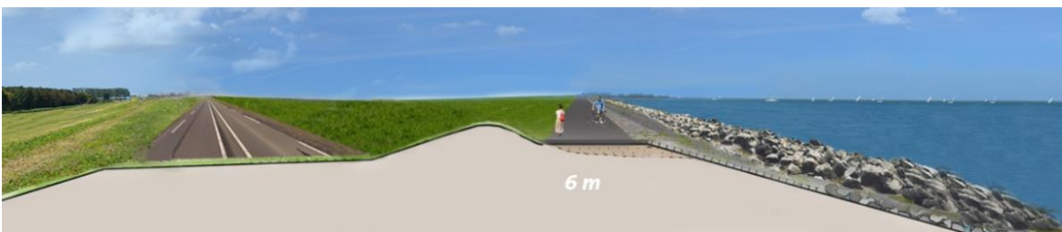
Figuur 3-6: Fotovisualisatie van de versterking voor traject Baaidijk (versterken zetsteen, teenversterking, verhoging buitenberm, nieuw asfalt aanbrengen)
