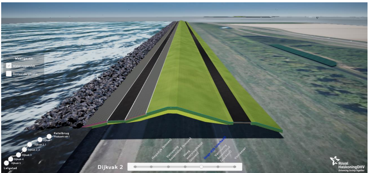
Figuur 2-16: Versterkingsprofiel alternatief Vierkante Versterking – Hoge Dijk, dijkvak 1/2 altn. 1.4 en 2.4
