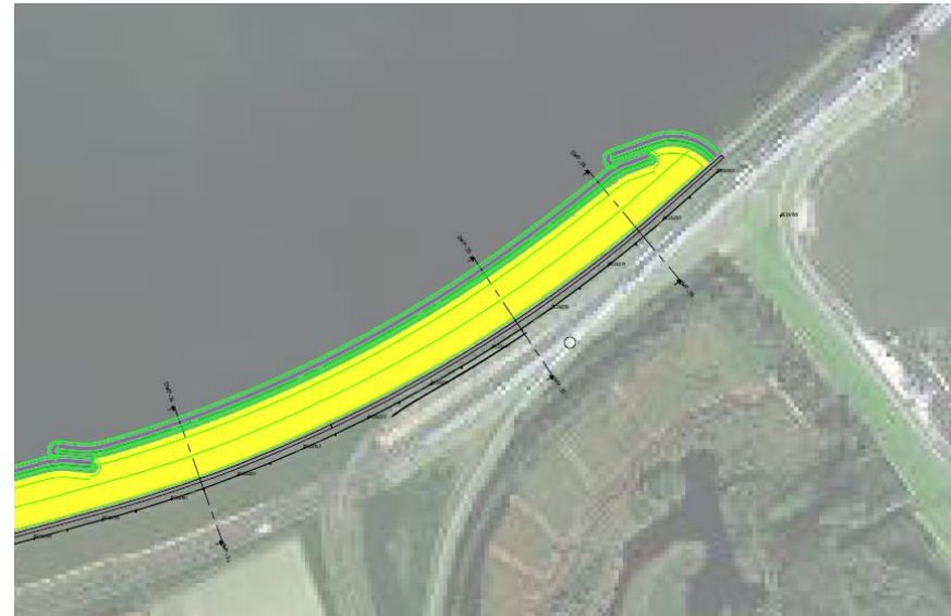
Bovenaanzicht met doorstroomopening in vooroeverdam
