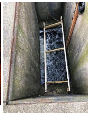
Figuur 24: proefopstelling beluchter in persbuis gemaal
