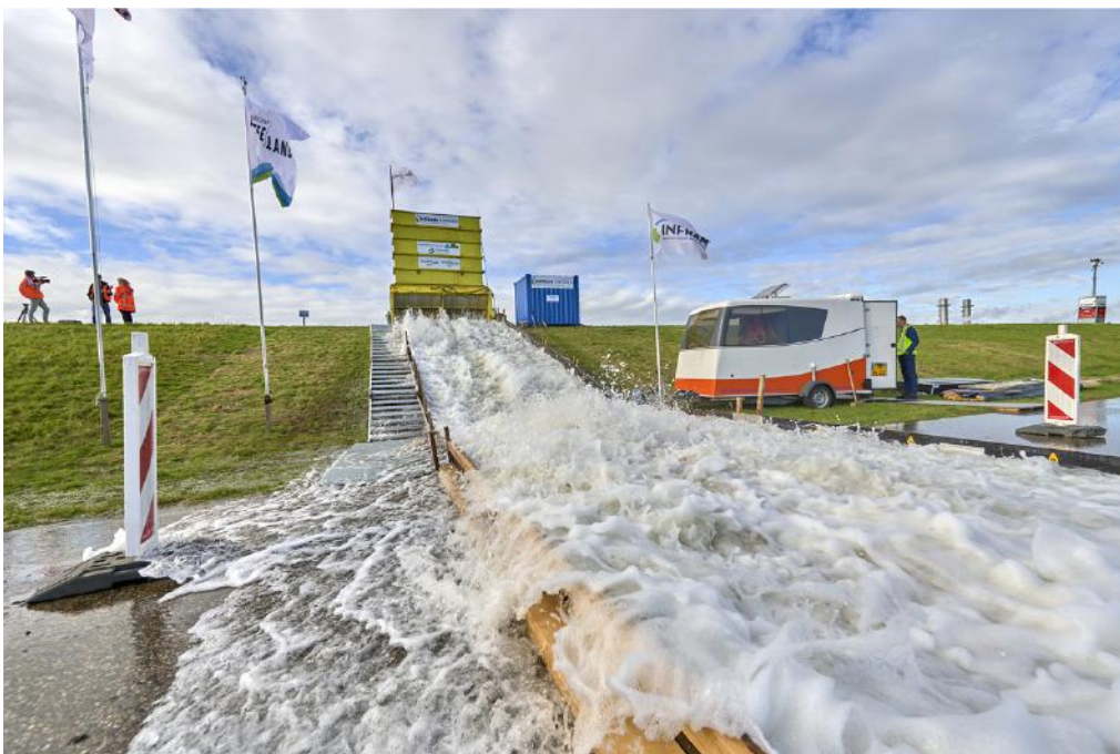
Figuur 13 Golfoverslagsimulatie tijdens overslagproef IJsselmeerdijk
