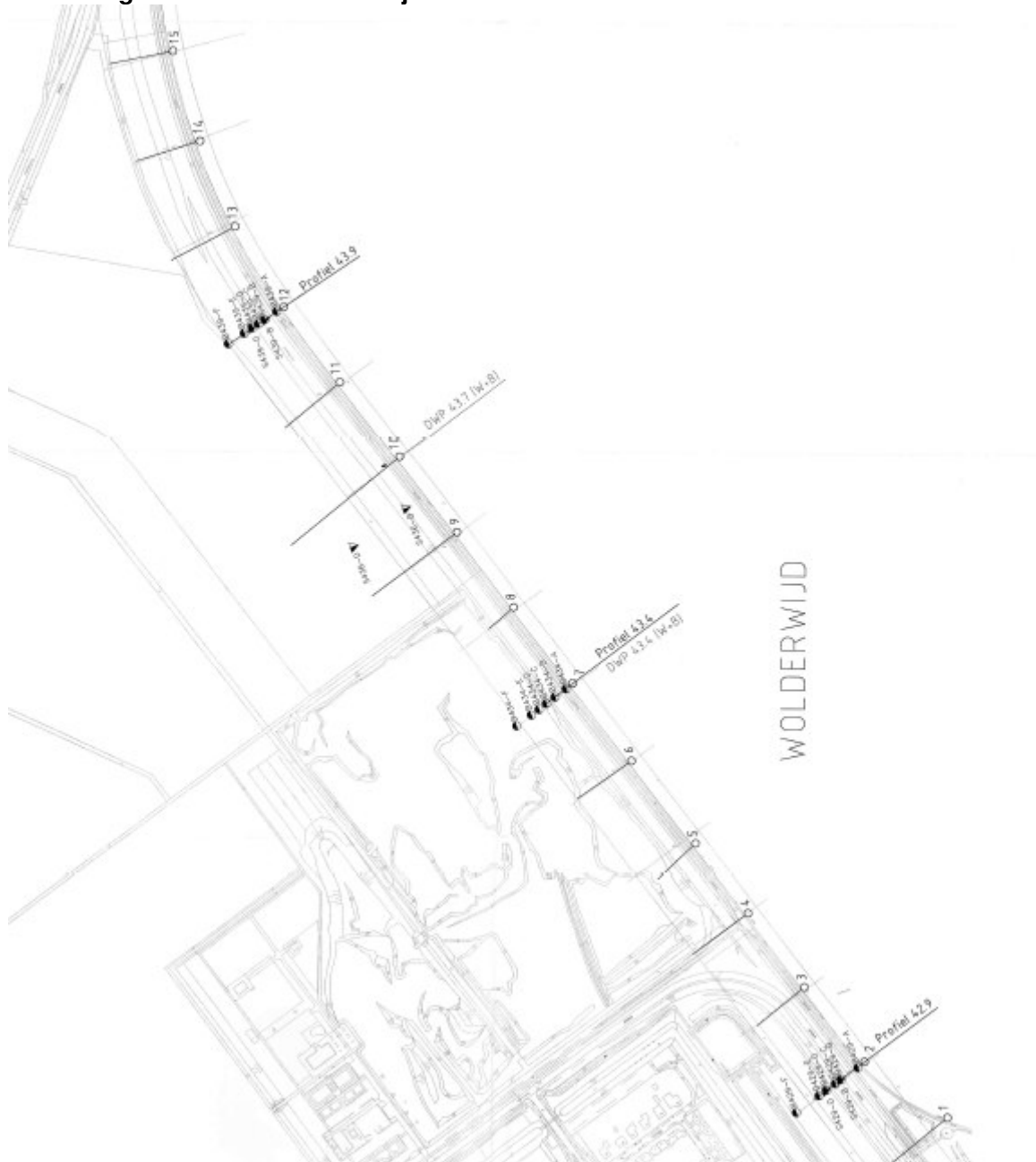
afbeelding I.5. Peilbuizen in de dijkzone
