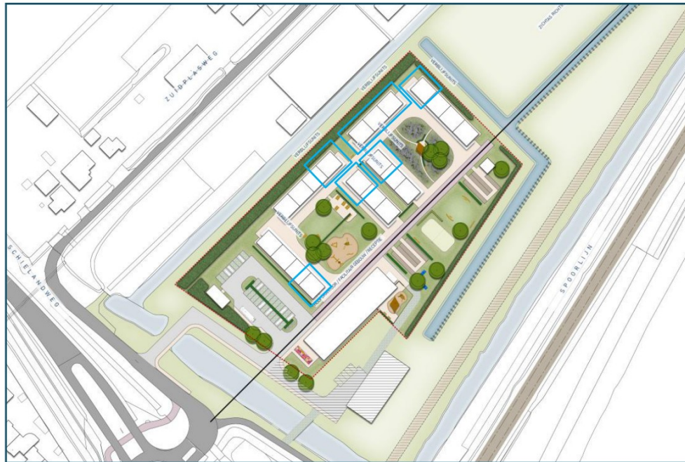
Figuur 14 Units met geluidluwe gevel (deel) (blauw omkaderd)
