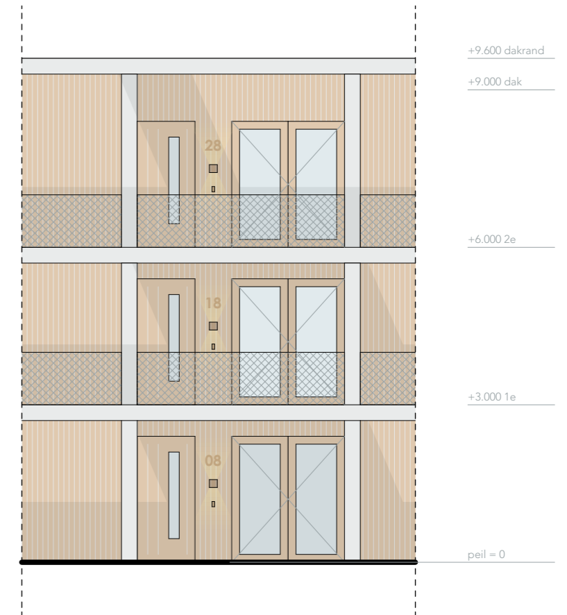
Gevelfragment "binnenzijde" 2-kamer
