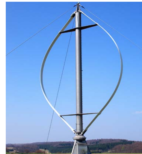
Duurzame energieopwekking als beleving (Darrieus rotor Ennabeuren)
