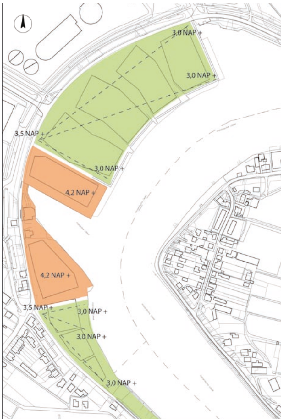
schematische weergave van de hoogteverschillen op de zellingen
