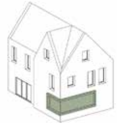
Vrijstaande woning met terugliggend dakvlak en bloemkozijn
