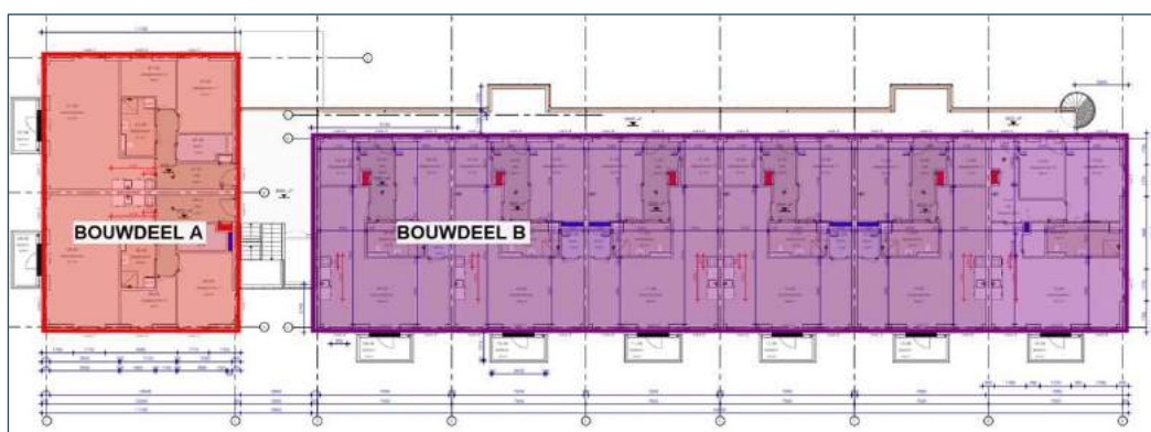
Figuur 3 Situering thermisch schil creëert twee bouwdelen.
